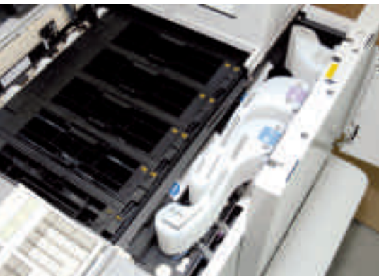
„Wie Auspuffkrümmer“: Vom Lift aus gelangen die Tabletten über die jeweilige Zuführung in den Subtank des entsprechenden Bades.
