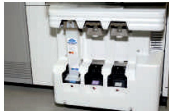
Lichtsignale: Rote LEDs weisen auf leere Kartuschenschächte hin. Blinken zeigt an, daß die eingesetzte Kartusche keine Tabletten mehr enthält und gewechselt werden muß.
