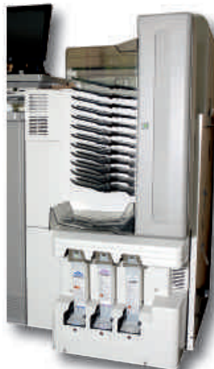
Komplett: die bestückte Ecojet-Aufnahmeeinheit am QSS-3501J.
