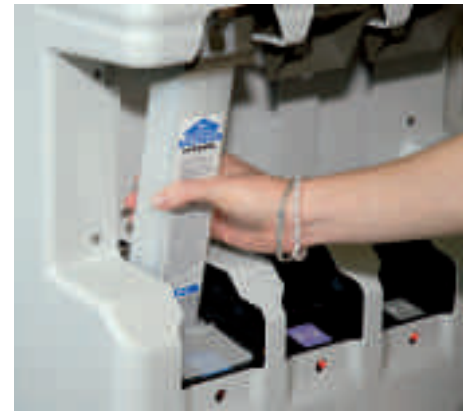
Leicht bestückt: Die „richtige“ Kartusche wird oben in die Führungshülse gesteckt (l.) und bis zum Einrasten nach hinten gedrückt (r.). Dabei öffnet sich der Bodenschieber (Shutter) der Kartusche nach vorn.
