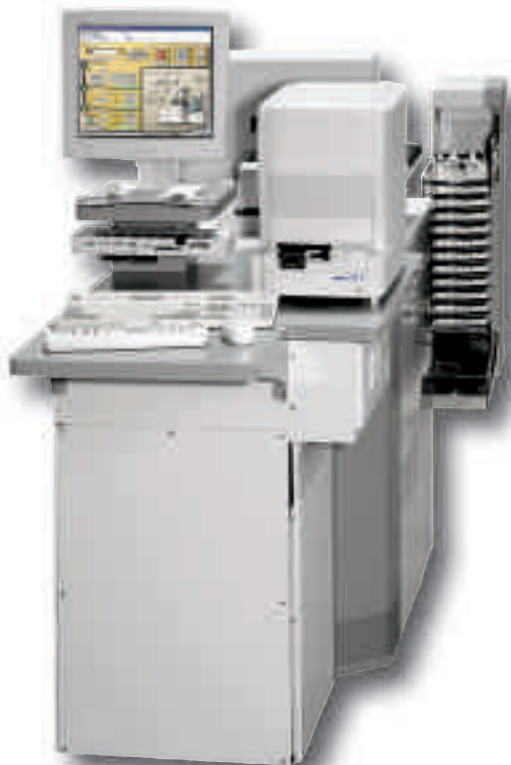
Von der Stirnseite aus: „Touch screen“-Monitor, S1-II-Filmscanner, MD-Kartenblock, Tastaturen und Maus können um 90 Grad versetzt angeordnet werden. Vor Kopf ist gut der angeschraubte Erweiterungs-tisch zu sehen.
