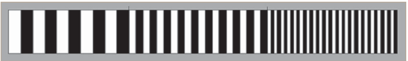
Linienmuster zur Bestimmung der Auflösungsfähigkeit.
