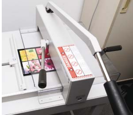
Ohne Kraftanstrengung: Mit dem Stapelschneider Ideal 4205 wird das fertig montierte Fotobuch aufs Endmaß gebracht.
