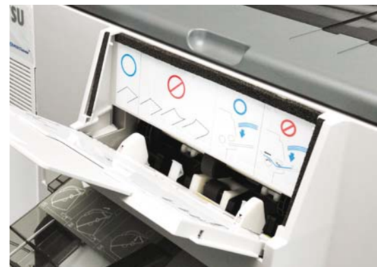
Stück für Stück: Die Einzelblattaufgabe am Einzelblatteinzug – oberhalb des Einzugs fürs Zweitmagazin – nimmt bis zu 20 Bogen auf.
