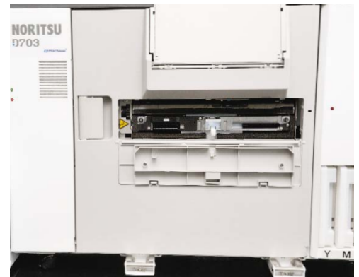
Sonst durch die heruntergeklappte Abdeckung geschlossen: der Einzug fürs zweite Magazin (M.). Unten sind die Kufen zu sehen, die das Magazin unten fixieren.
