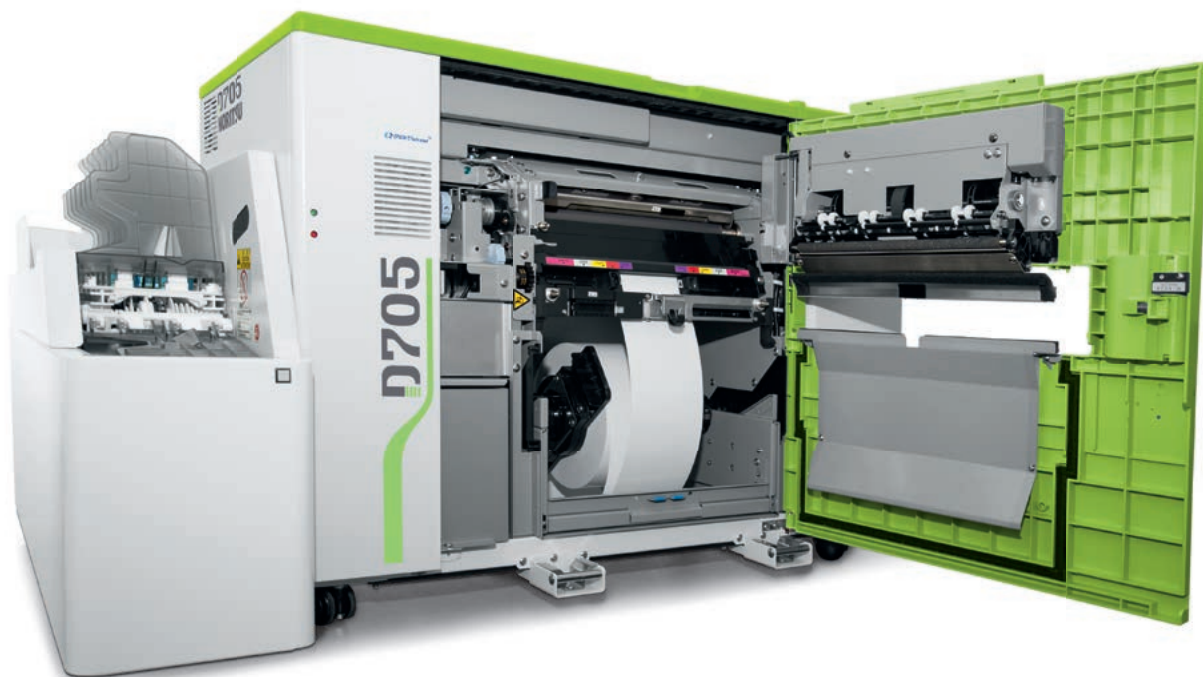
► Leicht zugänglich: Hinter der Fronttür befindet sich die Aufnahme des internen Papiermagazins.
