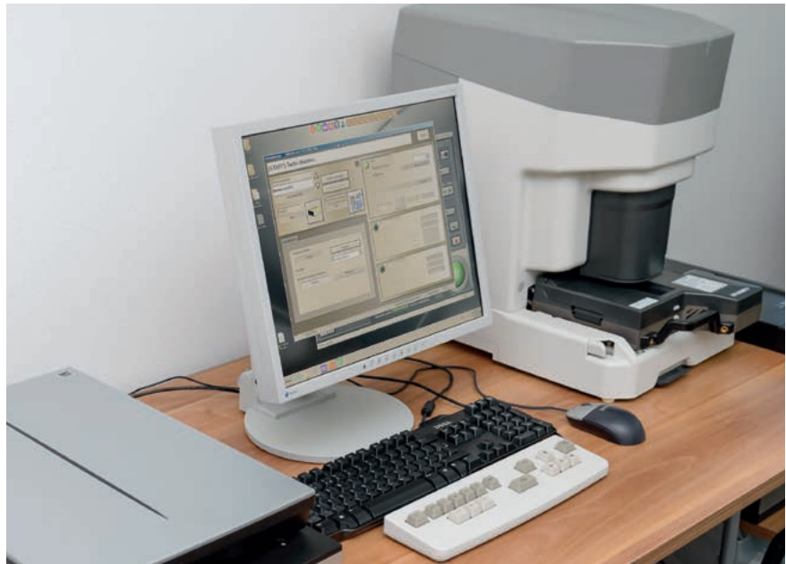
➤ Ein Arbeitsplatz fürs Digitalisieren von Filmmaterial und Aufsichtsvorlagen mit Vorlagen-scanner, Arbeitsstation mit Monitor und Noritsu-Filmscanner HS-1800. Abb.: fe
