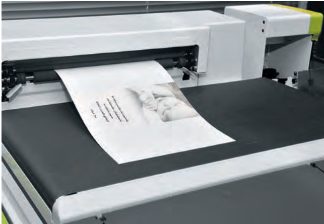
► Im sogenannten „Widerdruck“ (Fachausdruck) wird dann die Rückseite des Bogens bedruckt. Die dazu passende Druckdatei wählt der „EZ Controller“ selbsttätig aus.
