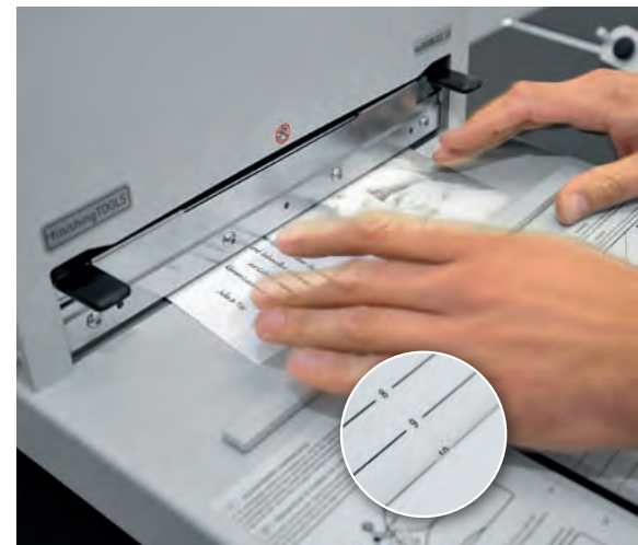
► Mit einem Falzgerät, wie dem „Opus Multcrease 30“, wird der zuvor aufs End-maß beschnittene Bogen – hier bei 10 cm, wie der Anschlag zeigt – mittig gefalzt.
