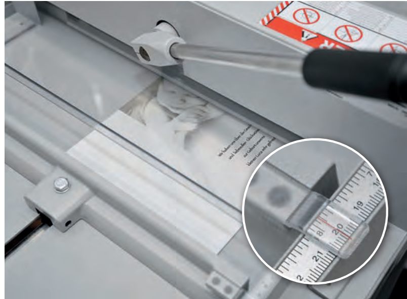
► Der Anschlag der Schneidemaschine wird an der 20-cm-Position fixiert. Mit der Karteninnenseite nach oben positioniert, schneidet man den 9,7 cm breiten Überhang ab und erreicht so das Endmaß des Bogens.
