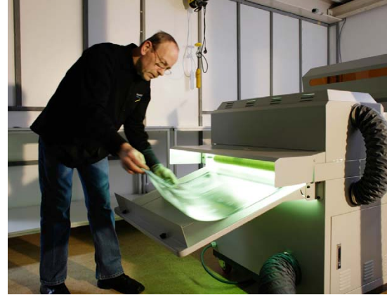
Zum Schutz vor äußeren Einflüssen, wie Feuchtigkeit, Schmutz und Fingerschweiß, erhalten Fotos und Buchseiten eine feine Schutzlackierung.
