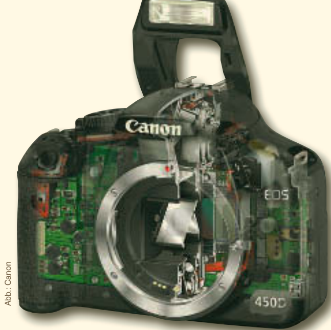
Hinter dem Spiegel ist der von Canon verwendete CMOS-Sensor gut erkennbar.
