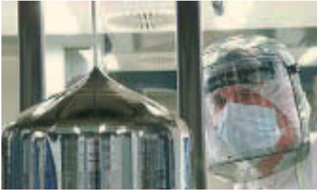
Silizium-Einkristall in der Fertigung.
