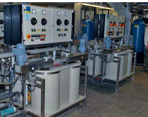
Wertvoll: Mit diesen Anlagen gewinnen die Münchener jährlich knapp drei Tonnen Silber aus den Bädern. Einst waren es bis zu vier Tonnen. Durch veränderte Technologie ist der Silbergehalt in Filmen und Papieren deutlich geringer geworden.
