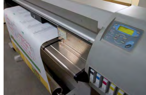
Auch in der Ink-Jet-Technologie zeigt Fayer Größe: Auf die verschiedensten Materialien können bis zu 1,60 m breite Drucke ausgegeben werden.
