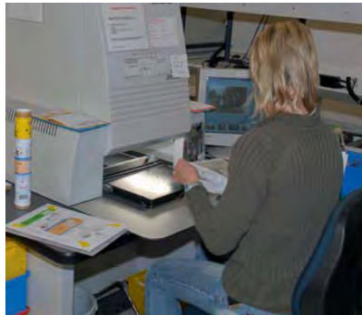
Integriert: Hier werden Bild-vom-Bild-Vorlagen gescannt und die Bilddaten via Netzwerk ans 3411 übergeben.
