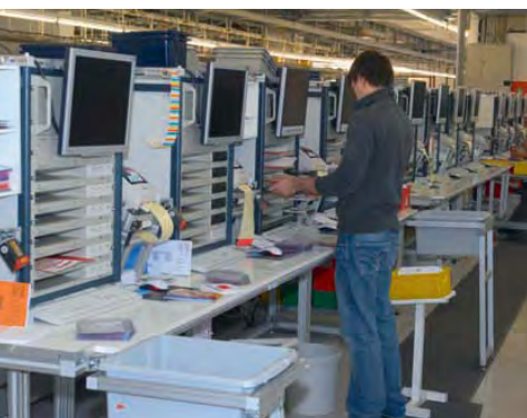
Eingabezone: An diesen Terminals werden digitale Speichermedien ausgelesen. Ein Mitarbeiter „füttert“ jeweils mehrere Stationen.
