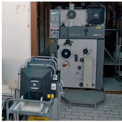
Die beiden letzten der Agfa-Fertigung sind im Münchener CeWe-Labor im Einsatz: Im Bild die Front einer der Durchlauf-Filmentwicklungsmaschinen des Typs CF2.
