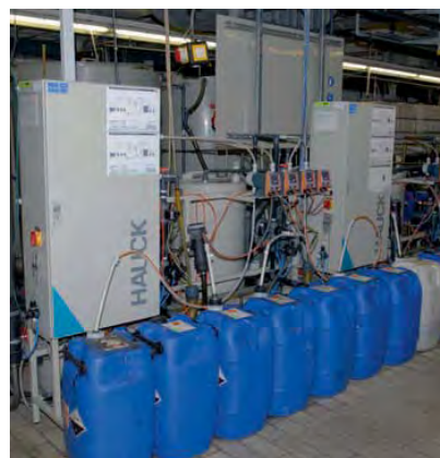
Kreislauf: In der Contimixanlage werden die Bäder überprüft und mit Konzentrat wieder aufgefrischt.
