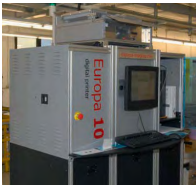
Mit Wasserkühlung (o.): der Europa-Printer von der amerikanischen Firma Express Imaging Systems (EIS).
