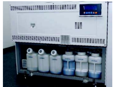
Auf der Vorderseite des Papierprozessors: das Prosser-Bedienfeld mit LCD-Anzeige (o.). Aufgereiht: Die Regenerat- und Überlauftanks sind gut zugänglich unten im LPS-Prosser plaziert.
