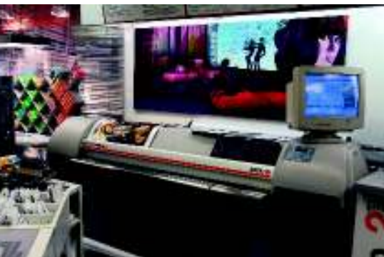
Natürlich auch vorhanden: Großbilder mit mehr als 60 cm Breite geben die Hamburger über zwei „Large Format Printer“ (i. Bild der Agfa Grand Sherpa 50) aus.
