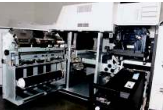
Alles nur größer: Von den Papiermagazinen (r.) gelangt das Fotopapier zunächst zum Belichtungsdeck (M). Darüber ist der Laser angeordnet. Nach dem „Belichten“ wird das Papier von der Übergabeeinheit (l. ausgezogen) an den Prosser übergeben.
