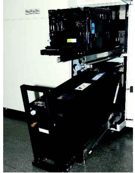
Griffbereit: Das obere 305-mm-Magazin ruht auf einem ausziehbaren Schlitten. Fürs Entnehmen und Einsetzen des 622-mm-Papiermagazins (u.) verfügt der Printer des LPS-24PRO über eine praktische Klapprampe.
