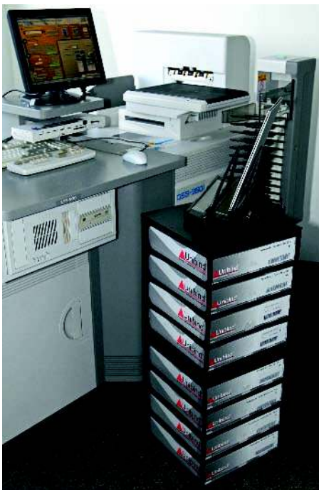
Fotobuch-Modul: Das Unibind-Einsteiger-Set besteht aus zwei stapelfähigen 4er Racks mit insgesamt 80 Einbänden und dem XU-138-Bindegerät.
