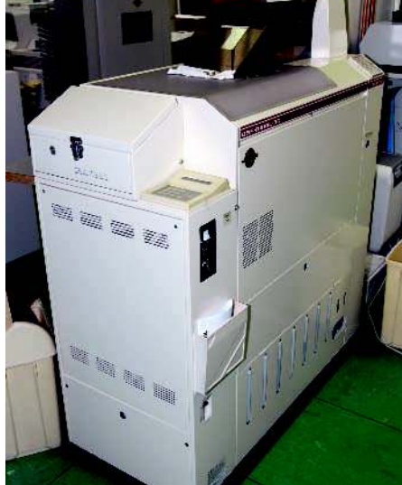
Bei Jan Kopp seit Herbst 2006 voll im Einsatz: Noritsu-E6-Filmentwicklungsmaschine QSF-R410L-3C.
