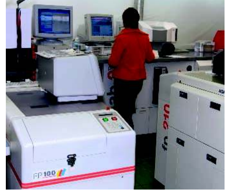
Teilansicht des Agfa-Equipments: vorn zwei Filmentwicklungsmaschinen, im Hintergrund eines von zwei d-2-Labs.
