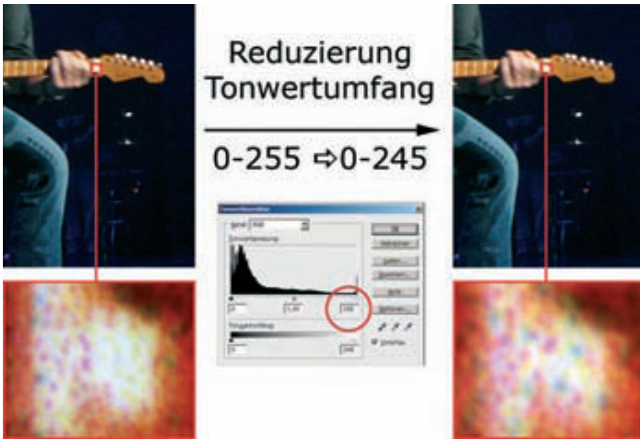
Abb. 7: Eine Reduzierung des Tonwertumfangs verursacht nur eine minimale Abdunklung des Bildes. Dafür gibt es aber kein 100prozentiges Weiß mehr im Druck, und der Ink-Jet-Drucker ist gezwungen, entsprechende Bereiche mit Farbe zu füllen. Beim Vergleich (s.o.) ist gut erkennbar, wie sich die Verteilung der „dots“ durch eine Reduzierung des Tonwertumfangs verändert.
