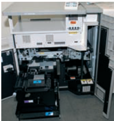
Leicht zugänglich: In der Standardausführung werden die 35-Plus-Geräte mit einem Papiermagazin geliefert, das auf einem ausziehbaren Schlitten (l.) ruht.
