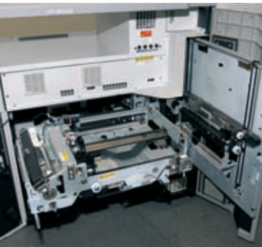
Von links nach rechts: Vom darunterliegenden Magazin wird das Papier über die „Paper Supply Unit A“ (M.) dem Laser zugeführt und mit Hilfe der „Paper Advance Unit“ (Reverse Unit) (r.) an den Papierprosser übergeben.
