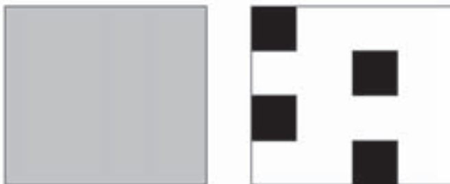
Abb. 3. Auf dem Bildschirm wird ein einzelnes Pixel als 25prozentiger Grauwert dargestellt. Die linke Abbildung zeigt ein Pixel nach der Ausgabe mit einem Halbtondrucker, die rechte die Wiedergabe mit einem einfachen Rasterdrucker, beispielsweise einem Laserdrucker.
