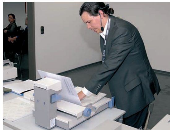
Abb. 13: Zum Schluß wird der Buchblock in den Umschlag eingehängt.
