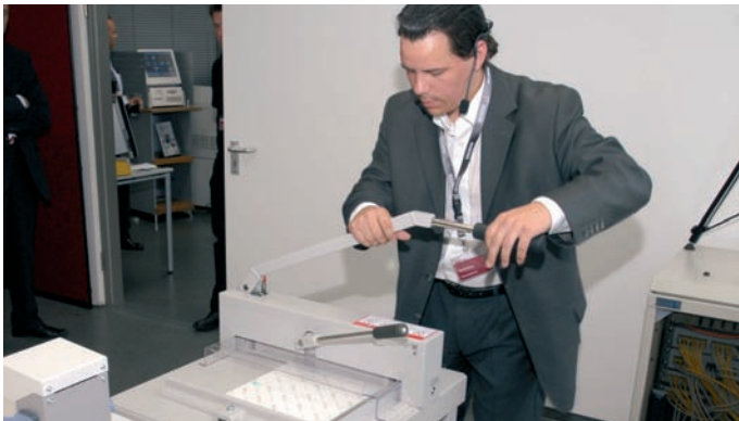
Abb. 7: Abschließend wird der Buchblock am Stapelschneider rundum sauber beschnitten.
