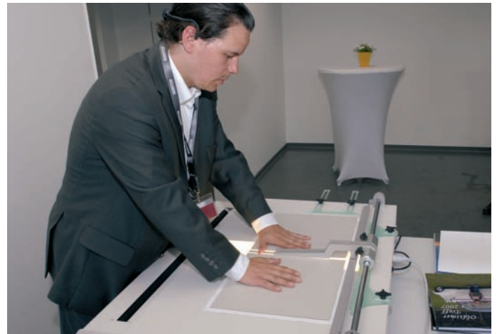
Abb. 9: 2,5 bis 3 Millimeter starke Graupappen bilden den Kern des Umschlags.
