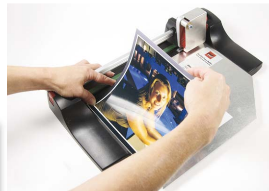
Nun wird die Gegenseite mit der Bildseite nach oben an den Anschlägen angelegt und exakt auf dem Rücken der ersten Seite positioniert. Danach braucht nur noch die Klebekante fest angedrückt zu werden, und fertig ist eine beidseitige Fotobuchseite.
