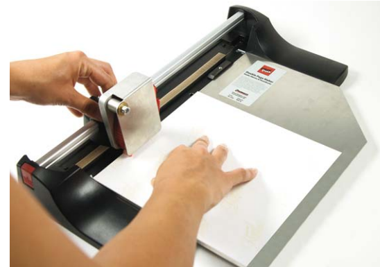
Mit dem Bildrücken nach oben wird die erste Bildseite am linken und am unteren Anschlag des „DoublePageMakers“ angelegt. Danach führt der Bediener den Schlitten mit dem Kleberoller von unten nach oben an der linken Bildkante entlang und bringt so einen 8 mm breiten Klebestreifen auf.
